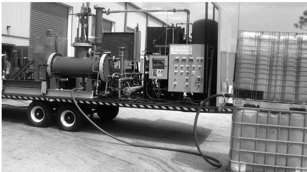
La macchina Plasma Arc Flow, che utilizza il fenomeno dell'ionizzazione per trasformare parte dei liquami in gas, il Magnegas
